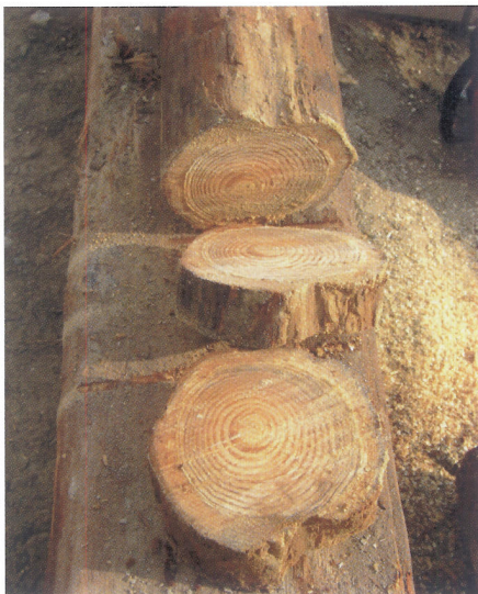
Abb. 16. Nach der Bergung wurden von einigen Holzbalken 15 cm dicke Scheiben als Holzproben entnommen. Das Foto zeigt die Entnahme eines dieser Probestücke.
